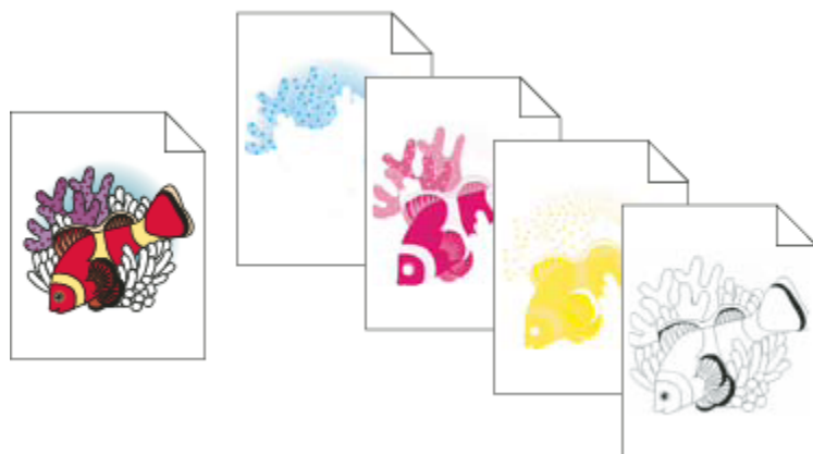
Složený obraz vytištěný na barevné laserové tiskárně a čtyři barevné výtažky vytištěné na osvitové jednotce.
